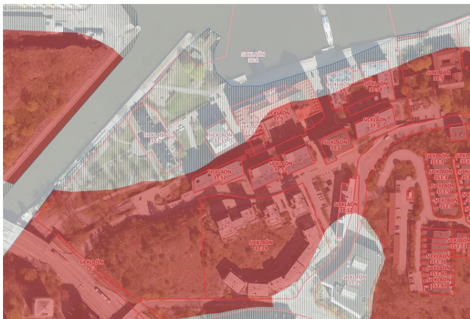
Figur 2. SGU:s övergripande jordartkartering visar berg (rött) och fyllnadsmaterial (blårandigt), 2025.
